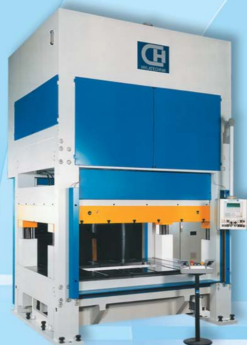
HSSP 300 * 3 * XA4 3000 kN Stanz- und Prägepresse für automatischen Betrieb (Abbildung ohne Peripheriegeräte), mit Schnittschlagdämpfung, Parallelhaltung und programmierbarer Pressensteuerung.
