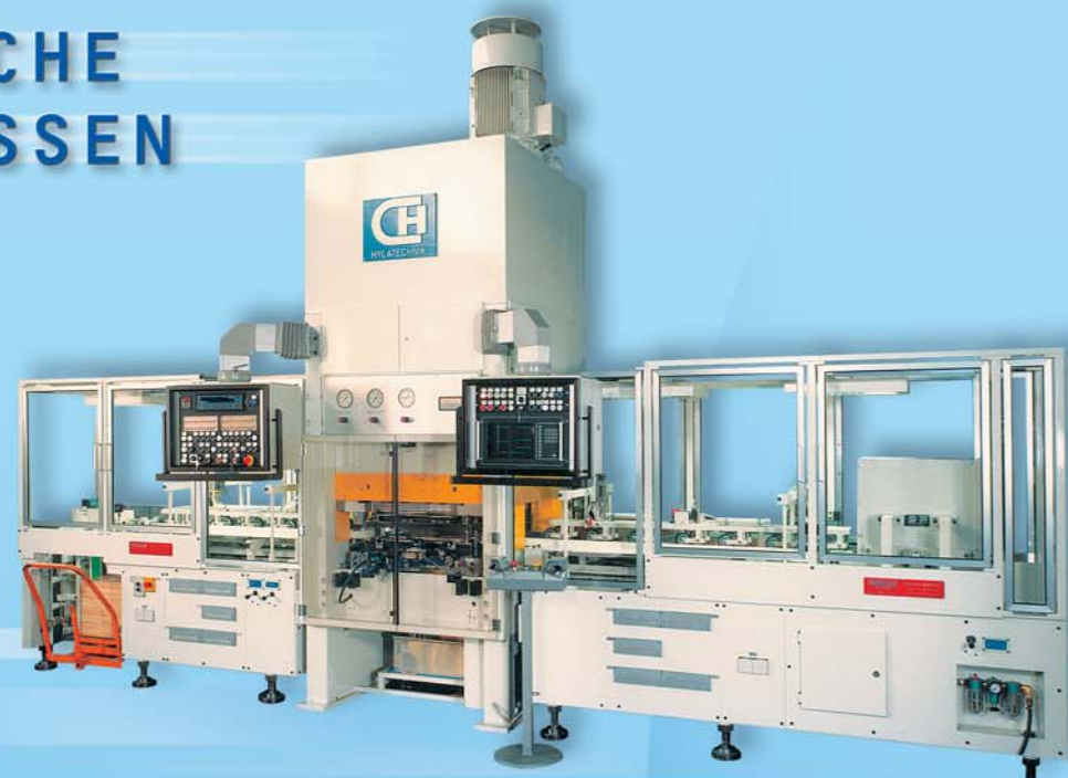
HSSP 100 * 1,5 * XA4 Hydraulischer Rasterlochautomat für Leiterplattenfertigung.
