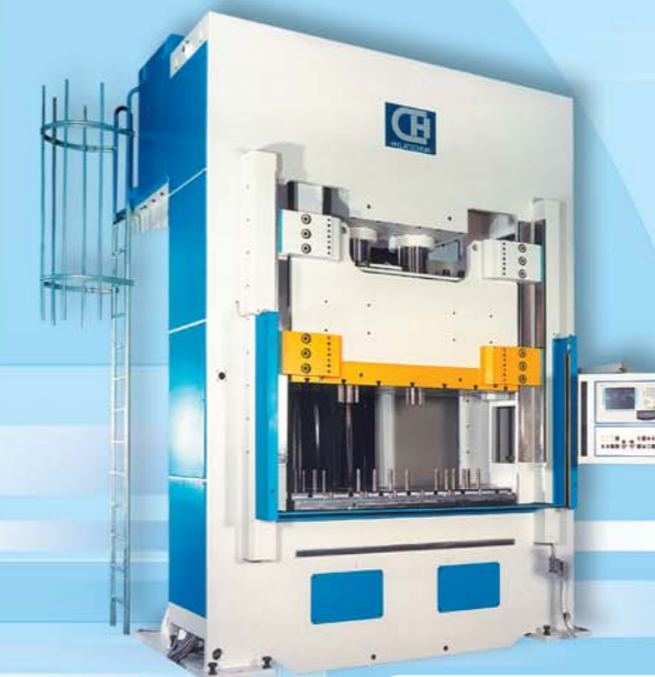
HZP 400 * 6 * XDS 4000 kN-dreifachwirkende Ziehpresse mit programmierbarer Pressensteuerung.
